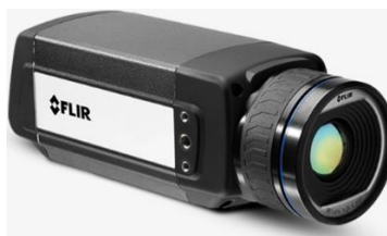
Figura 2: Ilustração da câmera termográfica utilizada.
