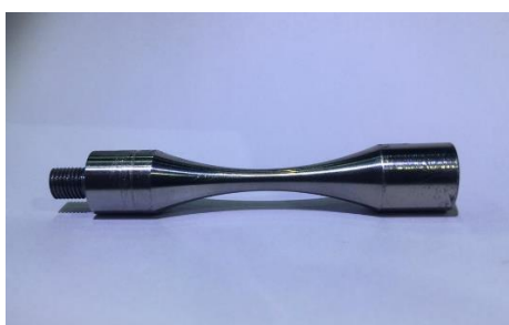
Figura 3: Corpo de prova no formato ampulheta utilizado nos ensaios.
